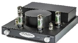
**Röhren-Vollverstärker**, 2x30 W mit 4x EL34, 3x Line In, AutoBias, 6N2P Treiberstufe, Wima Kondensatoren, Gitter und Fernbedienung, Farbe Schwarz
